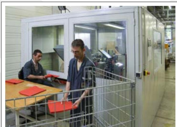
Rainurage et pliage des chemises sur l'assembleuse « Thiessen et Bonitz »
